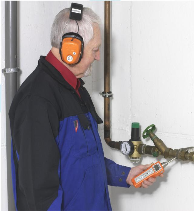
Lo STETHOPHON 04 è uno strumento elettronico per rilevare e amplificare rumori di ogni tipo, riproducendoli fedelmente e senza distorsioni.
